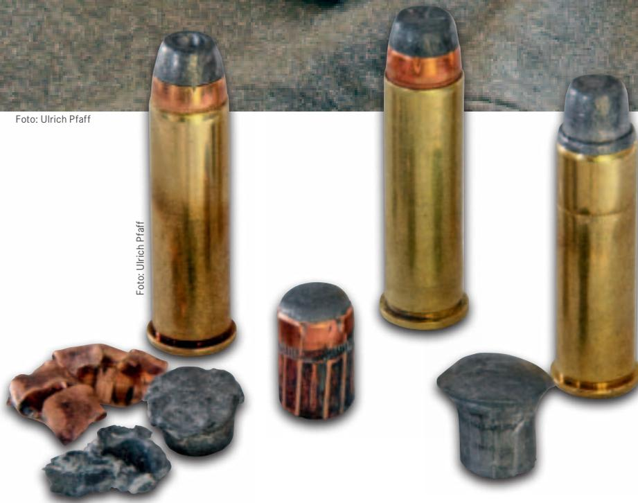
.357 Magnum: Links ein schnelles und sehr leichtes Teilmantel-Hohlschultergeschoss (Winchester 110 grain SPHP), das sich beim Auftreffen zerlegt und deshalb für den Fangschuss ungeeignet ist. In der Mitte ein typisches Teilmantel-Flachkopfgeschoss, das wenig deformiert. Das rechte, ein Blei-Semiwadcutter (Winchester 158 grain BISWC), verformt sich bei gleicher Geschwindigkeit auch ohne Hohlspitze sichtbar.
